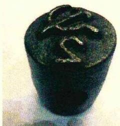
На экспертизу представлено клеймо лесничего – инструмент, с помощью которого работники лесного хозяйства наносят на деревья специальные пометки.
